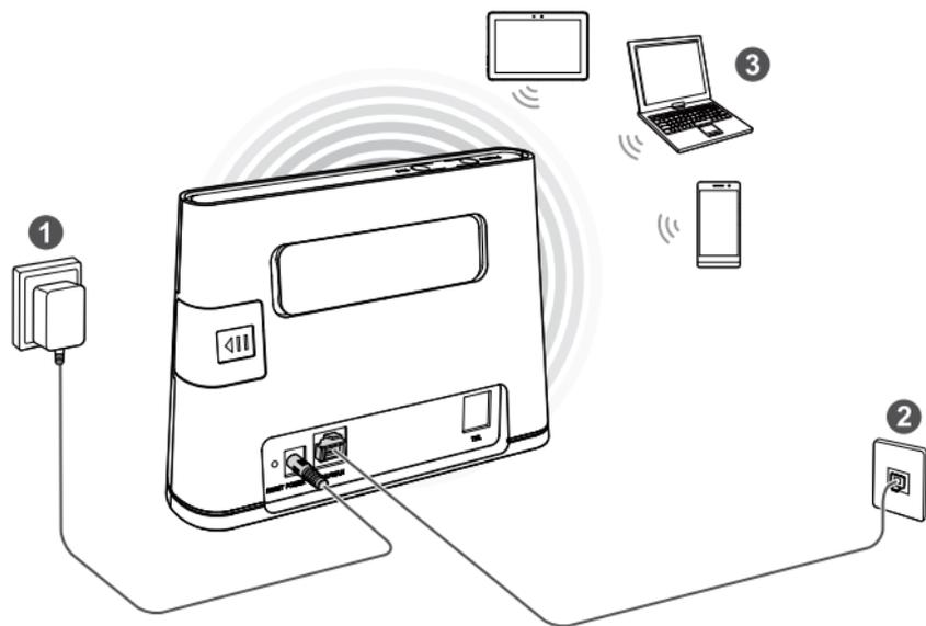
Una vez conectado a un tomacorriente, el B310 se enciende automáticamente.
