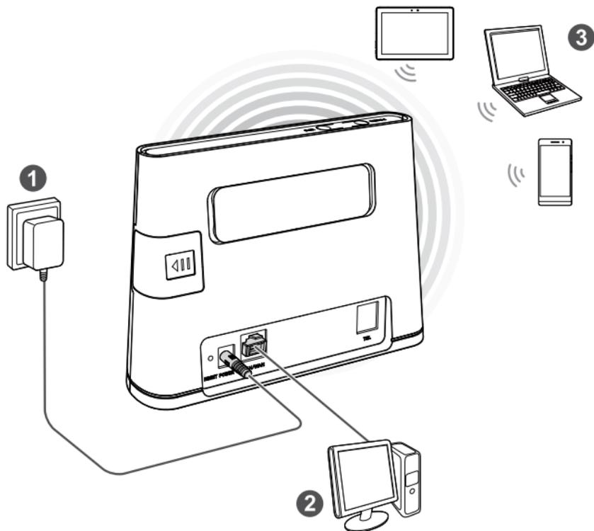
Una vez conectado a un tomacorriente, el B310 se enciende automáticamente.
